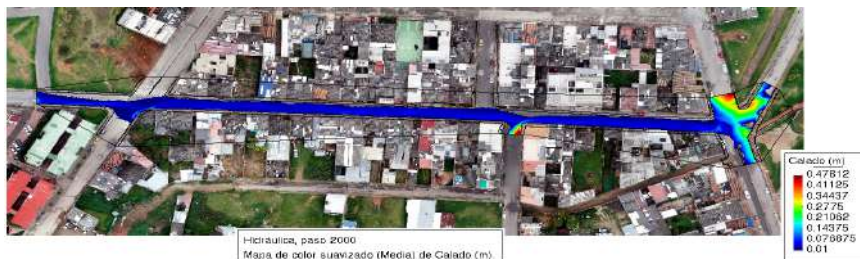
Ilustración 14. Lámina de agua en el escenario de topografía tradicional en el intervalo de 2000 segundos.
