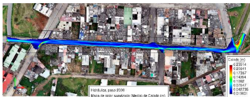
Ilustración 16. Lámina de agua en el escenario de topografía con dron en el intervalo de 2000 segundos.
