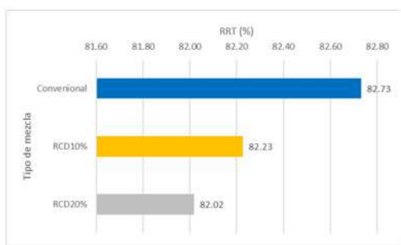
Figura 11. Resultados resistencia a la tracción ( RRT ) de las mezclas asfálticas.
