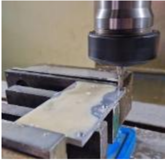
Fig. 5. Proceso de fresado de cuchilla de aluminio. Fuente: Autores del proyecto
