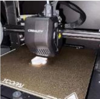
Fig. 6. Proceso de impresión 3D de la carcasa. Fuente: Autores del proyecto
