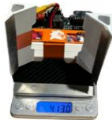
Fig. 15. Medición de masa del robot. Fuente: Autores del proyecto
