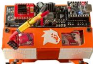
Fig. 16. Placa de control integrada en el robot. Fuente: Autores del proyecto
