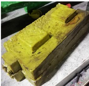
Fig. 3. Ladrillo plástico fundido con inyectora. Fuente: Autores
