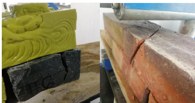
Fig. 4. Fallas a los dos muros. Fuente: Autores
