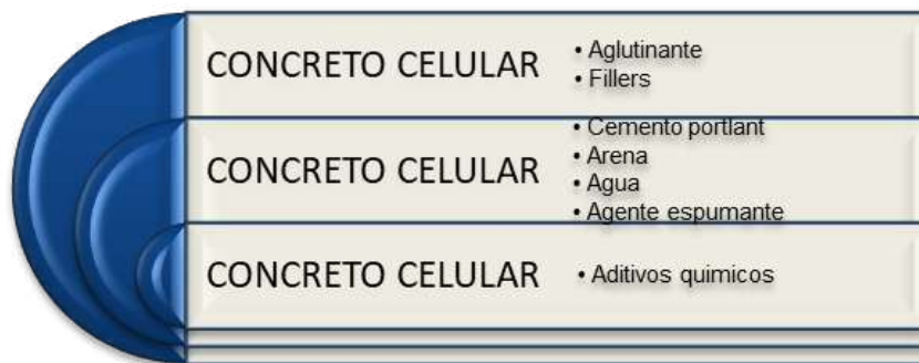
Figura. 5. Diferentes compuestos para preparar concreto celular.
