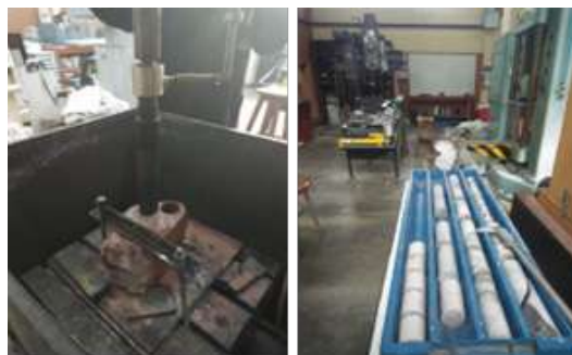
Figura 3: Extracción de probetas de roca de 5 cm de diámetro, mediante diamantina.
