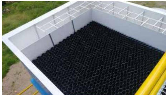
Figura 7. Proceso de sedimentación.
