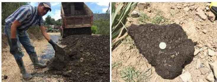
Figura 13. Irregularidades del material del fresado.
