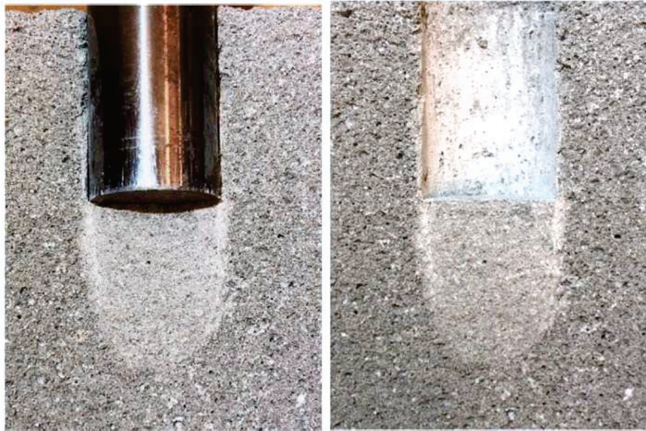
Fig. 10. Material densificado debajo de la penetración del equipo.
