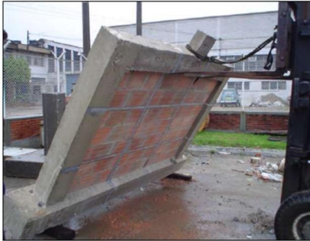
Fuente: Bastidas, E., Molina, L. (2004). Ensayo muro MCEDBG 01. [Tabla]. Recuperado de “Muros de mampostería reforzados con láminas de fibra de vidrio, sometidos a esfuerzos fuera del plano.”
