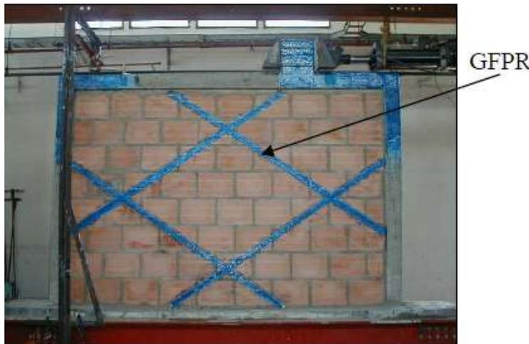
Fuente: Bastidas, E., Molina, L. (2004). Refuerzo externo con GFRP. [Tabla]. Recuperado de "Muros de mampostería reforzados con láminas de fibra de vidrio, sometidos a esfuerzos fuera del plano."
