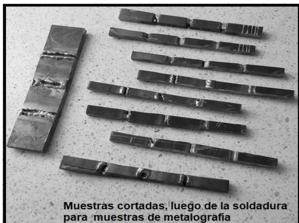
Figura 4. Muestras cortadas para Metalografía. Fuente: Autores.
