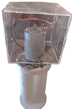
Figura 14: Microturbina hidráulica Savonius. Fuente: Elaboración propia.
