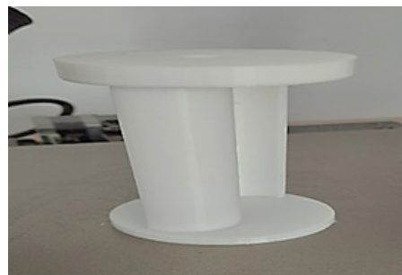
Figura 12: Rotor de la microturbina hidráulica Savonius.
