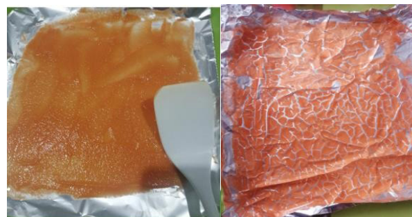
Figura 7. a) Mezcla del pitillo biodegradable. b) Lámina para la realización del pitillo fragmentada.
