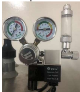
Fig. 9. Regulador de CO 2 utilizado para el sistema de control de presión.
