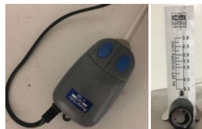
Fig. 8. Sistema de inyección de oxígeno al reactor.
