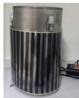
Fig. 5. Camisa térmica alrededor del reactor.
