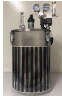
Fig. 12. Reactor bioquímico para producción de etanol por fermentación de biomasa de desecho.
